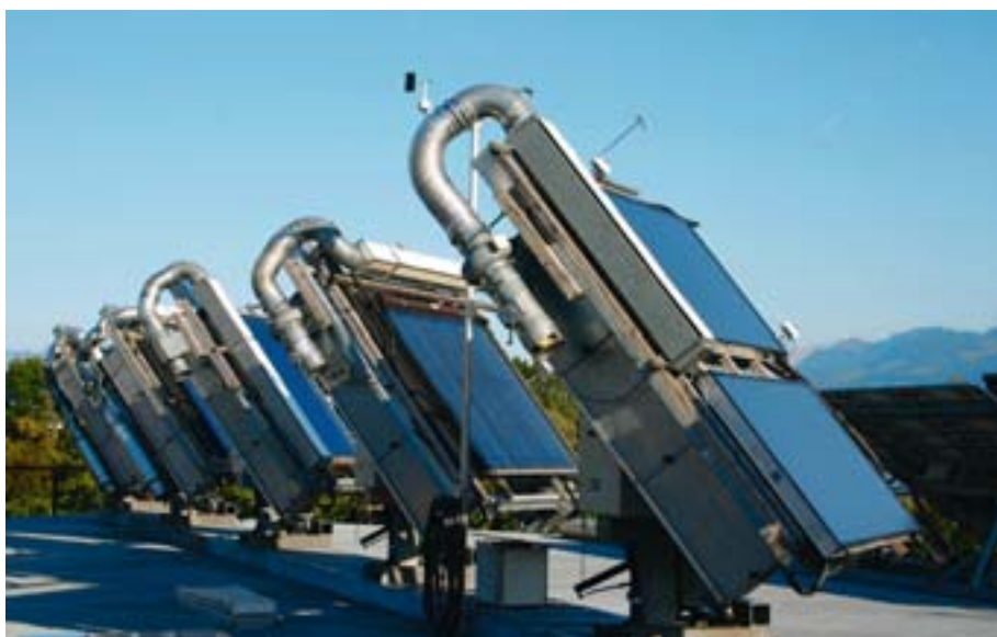
Die meisten Tests werden auf dem Outdoorstand auf dem Institutsdach durchgeführt, wo die Kollektoren in Reih und Glied aufgeständert sind
