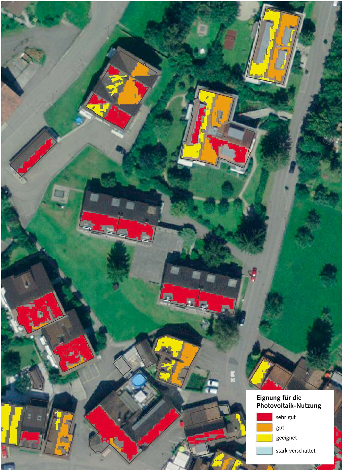
Eignung der Dachflächen für Solaranlagen in vier Klassen.
