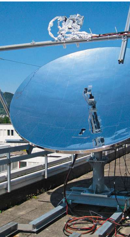
Solkonzentrator: Das System soll Sonnenlicht 2000-fach konzentrieren.
