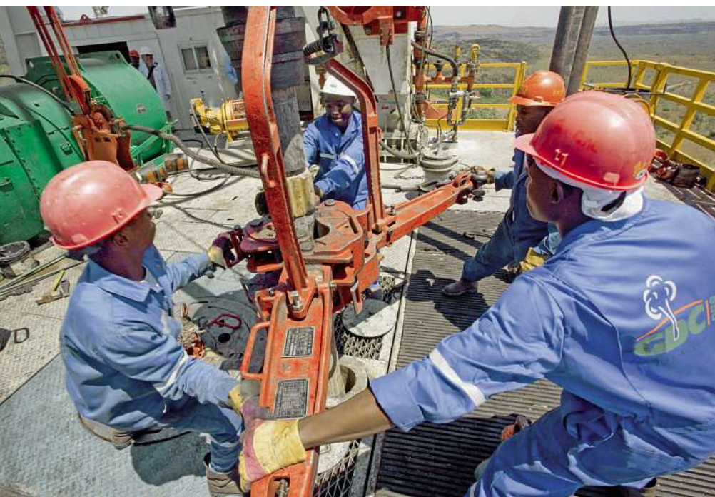
Montage einer neuen Bohrstange auf einem Geothermie-Bohrturm der «Geothermal Development Company» im Menengai Krater.
