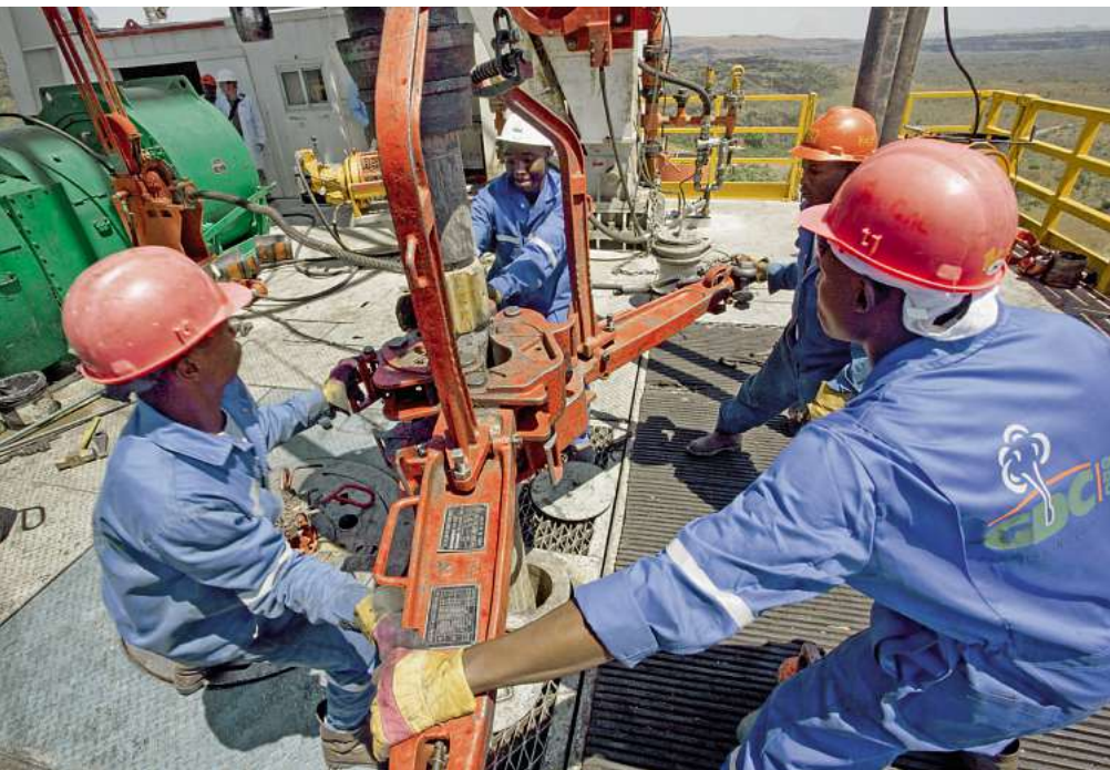
Assemblage d'une nouvelle tige de forage sur la tour de forage géothermique de «Geothermal Development Company» au cratère du Menengai.
