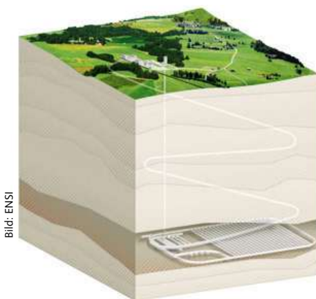
Grafische Darstellung eines Tiefenlagers. Die radioaktiven Abfälle werden per Stollenbahn über einen Schacht oder eine Rampe in die unterirdischen Lagerstollen gebracht und dort eingelagert.
