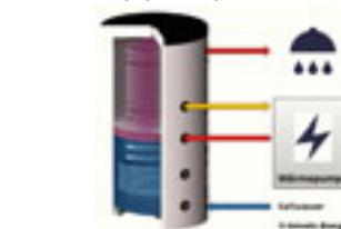
Beladung oben für Warmwasser-Bereitung (oben heiss, unten kalt)
