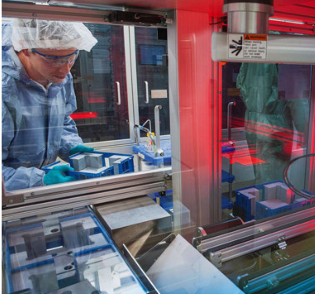
Gut genug? Am Ende moderner Produktionen werden die Solarzellen nach Wirkungsgraden sortiert.
