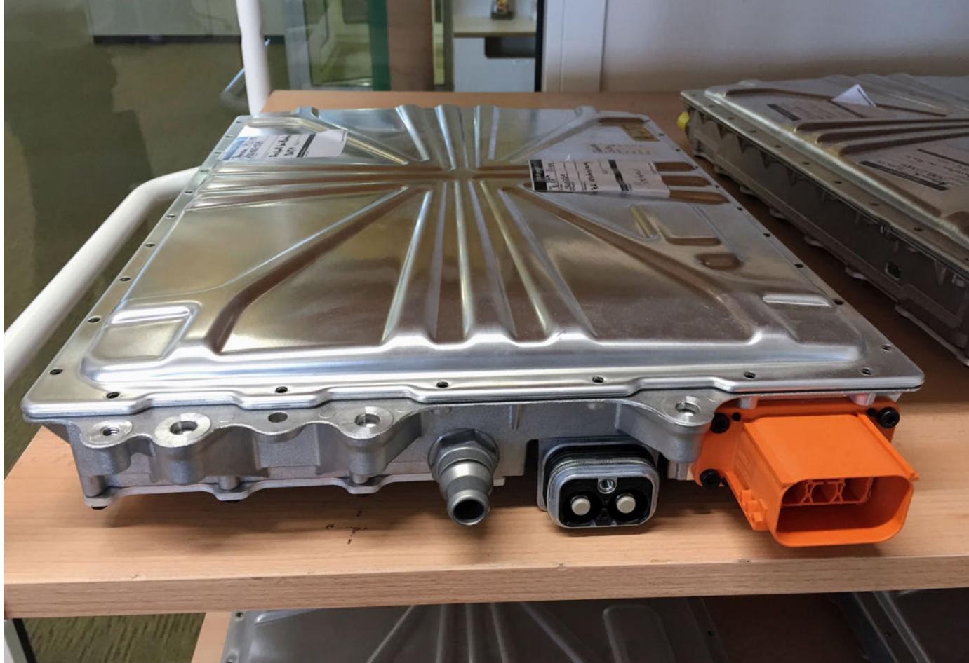
Ladegerät dieses Typs mit 22 kW Leistung werden zum Beispiel in den Elektro-Smart eingebaut.
