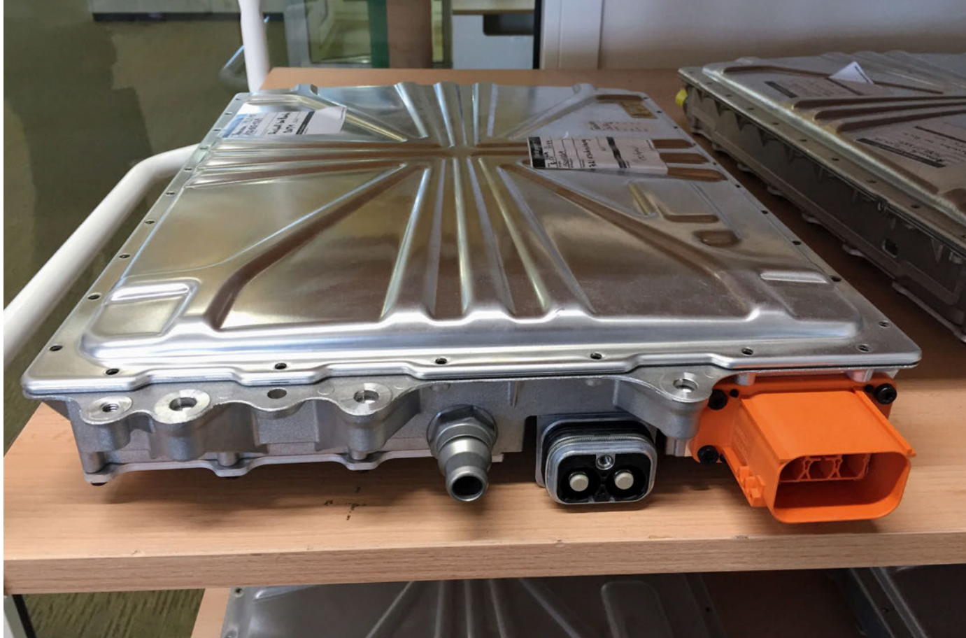
Des chargeurs de ce type d'une puissance de 22 kW sont intégrés, par exemple, dans la Smart électrique.
