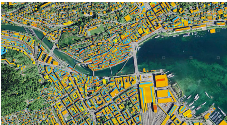
Der nationale Solarkataster zeigt wie hier am Beispiel von Luzern die Eignung zur Solarenergiegewinnung auf Dachflächen.
