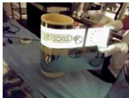
Im Roll-to-Roll-Verfahren gedruckt: Diese Technik legt den Grundstein für kostengünstige Solarzellen und LED-Leuchtflächen der Zukunft.
