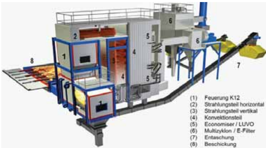
Die Biomassefeuerung in der Energiezentrale des Verteilzentrums Schafisheim.
