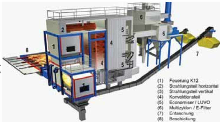
Le chauffage à biomasse dans la centrale énergétique du centre logistique de Schafisheim.
