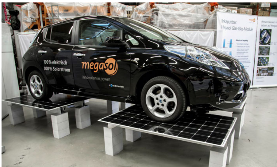
Wie stabil die in der neuen Fabrik gefertigten Module sind, stellt dieser Belastungstest unter Beweis.
