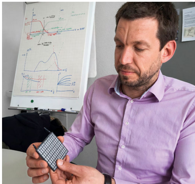
Dr. Corsin Battaglia untersucht am Materialforschungsinstitut Empa thermoelektrische Anwendungen beispielsweise zur Stromgewinnung aus Autoabgasen. Im Bild zeigt Battaglia einen kommerziell angebotenen thermoelektrischen Generator auf der Basis von Bismutellurid.
