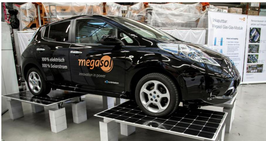
Ce test de mise en charge montre à quel point les modules fabriqués sont stables mécaniquement.
