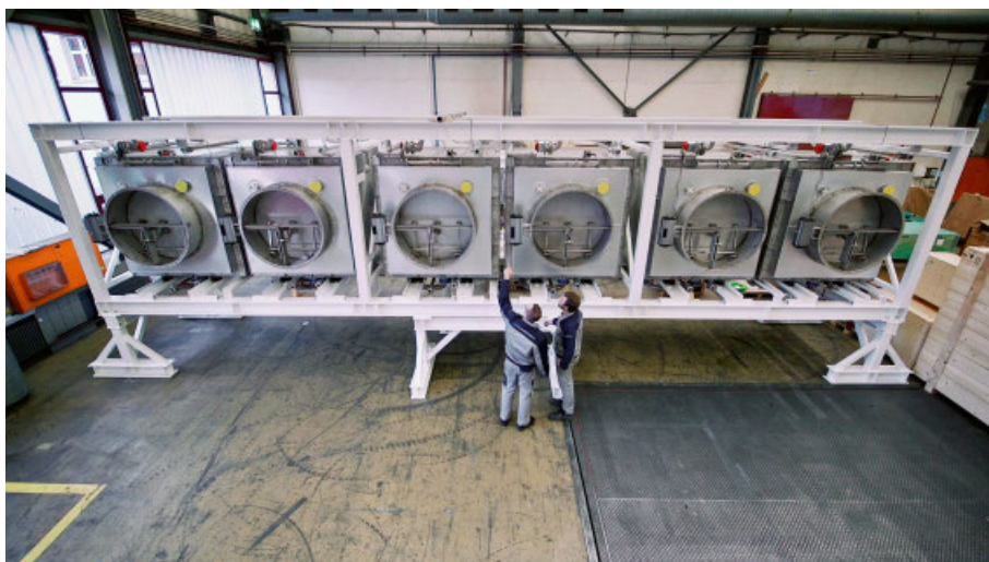
Jeweils sechs Module für die CO 2 -Abscheidung werden in einem 40-Fuss-Schiffscontainer untergebracht. In der Form stehen sie am Firmensitz von Climeworks in Zürich-Oerlikon bereit für den Einbau in der Anlage in Hinwil im Zürcher Oberland.
