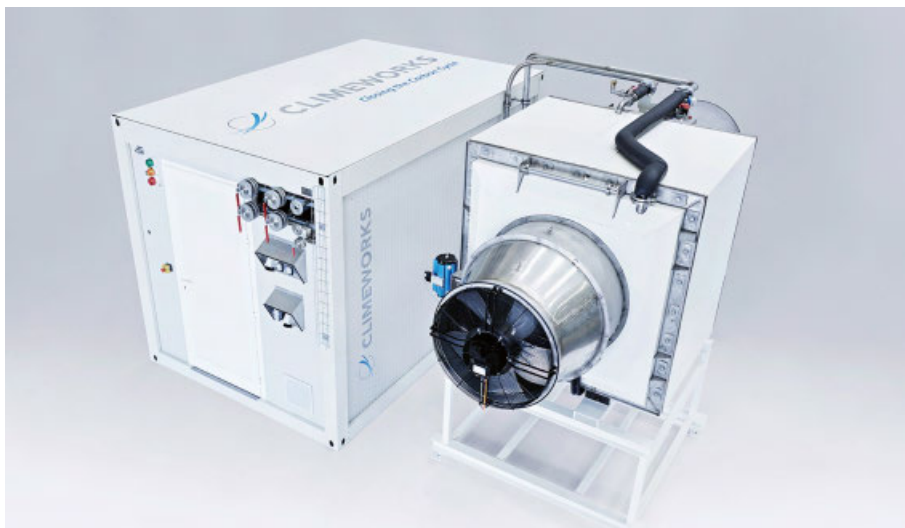
Ein Climeworks-Modul kann pro Jahr 50 t CO 2 aus der Luft abscheiden. 18 solche Module werden in Hinwil (ZH) zu einer grösseren Anlage kombiniert.
