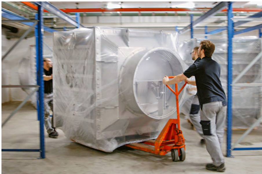
Die CO 2 -Abscheidemodule werden am Climeworks-Sitz in Zürich-Oerlikon gefertigt.
