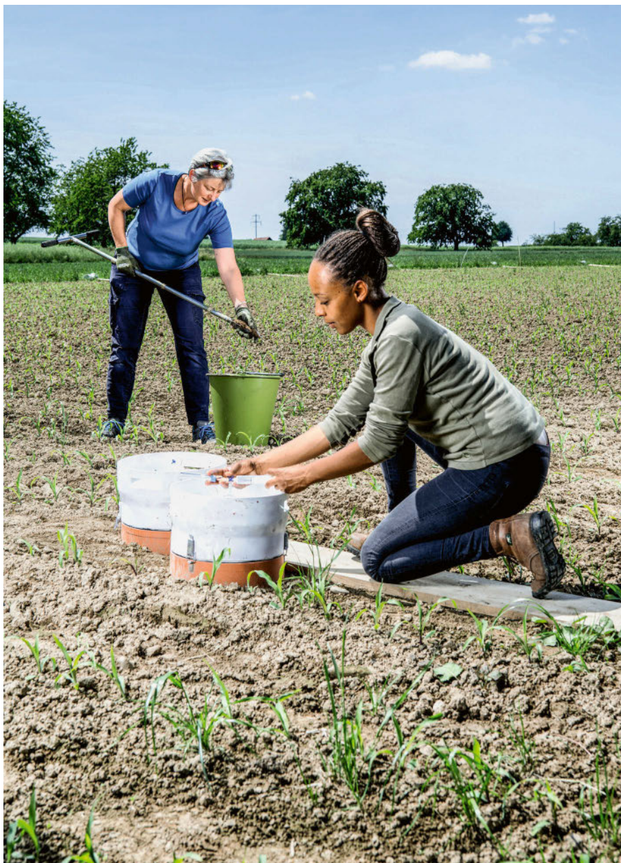
Norah Efosa (Institut de recherche en agriculture biologique) mesure les émissions de protoxyde d'azote et de méthane dans un champ de maïs à Wallbach, en Argovie (en arrière-plan: la directrice du projet, D'Else Bünemann). Auparavant, le lisier fermenté et non fermenté était épandu sur des parcelles de terrain de 9 x 18 mètres.
