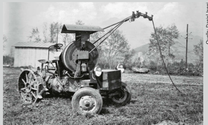
Die Entwicklung aus den Kriegsjahren bezog ihre Energie über eine Kabelrolle.
