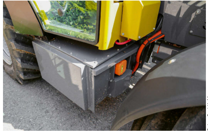
Die Batterie unter der Führerkabine sorgt für einen tiefen Schwerpunkt, was für die Arbeit im Gelände wichtig ist.
