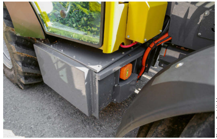
La batterie située sous la cabine de conduite offre un centre de gravité bas, ce qui est important pour travailler sur le terrain.
