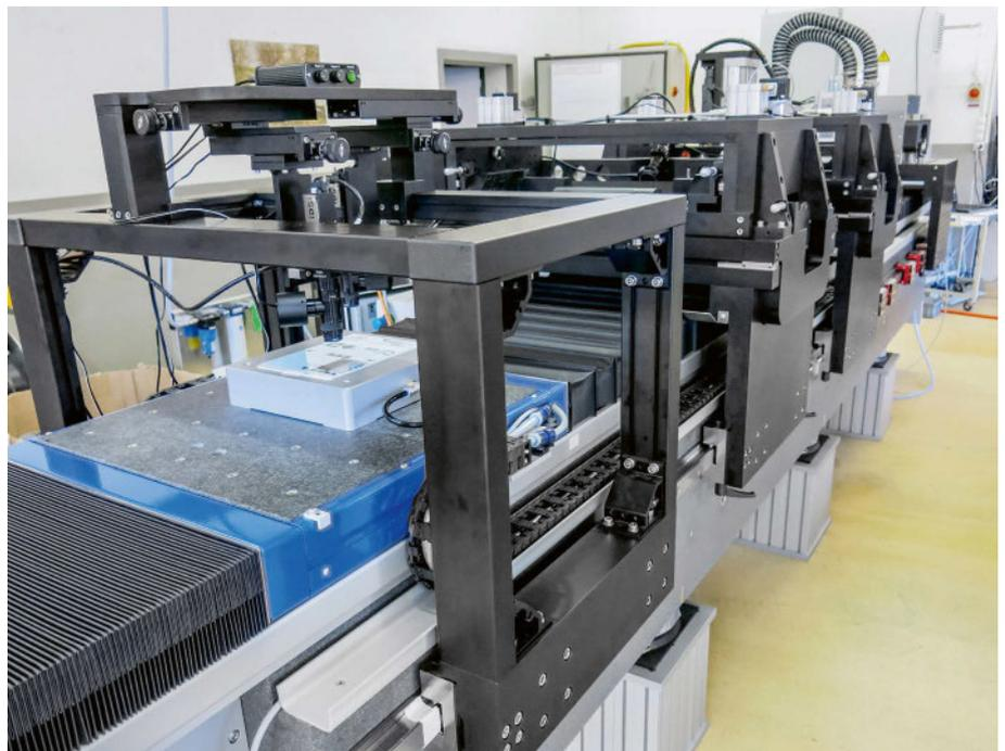
Die Beschichtungsplattform C600, mit der an der Empa Perowskit-Solarzellen im Schlitzdüsenverfahren hergestellt werden
