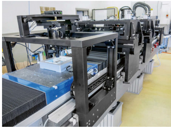
La plateforme d'enduction C600 avec laquelle sont construites les cellules solaires à base de pérovskite à l'Empa avec le procédé des buses à fente.
