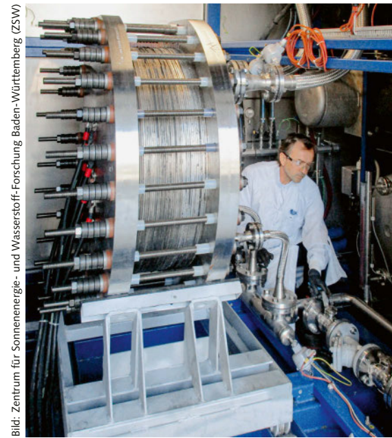
Bild: Zentrum für Sonnenenergie- und Wasserstoff-Forschung Baden-Württemberg (ZSW) Forscher am ZSW-Teststand für alkalische Druckelektrolyseblöcke.
