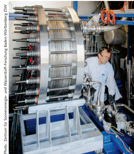
Photo : Zentrum für Sonnenenergie- und Wasserstoff-Forschung Baden-Württemberg ZSW Chercheur au banc d'essai ZSW pour les blocs d'électrolyse à pression alcaline
