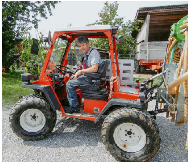
Guido Winterberg et le Metrac électrifié – la batterie stocke 40 kWh
