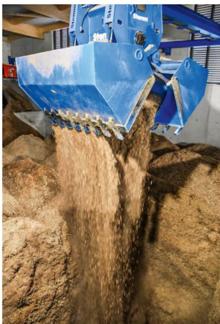
Aus dem Sägewerk fallen jährlich rund 10 000 m<sup>3</sup> Holznebenprodukte (Kernholz-Hackgut, Sägemehl, zerleinerte Rinde) an, die im Holzheizwerk zur Wärmeproduktion genutzt werden. Die Nebenprodukte (vorwiegend Laubhölzer) sind sehr heterogen.
