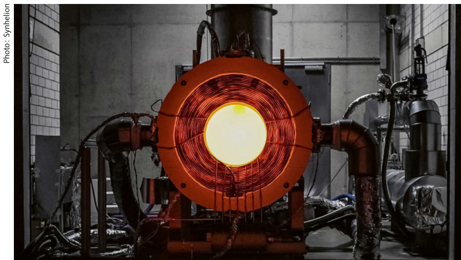
Dans ce Solar-Receiver, la lumière du soleil permet de générer une température de 1500° C.
