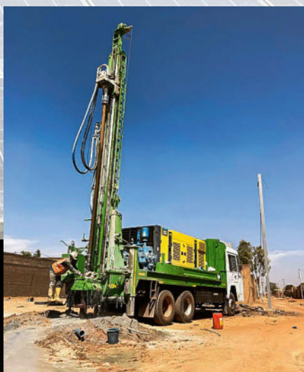
Les camions de forage de puits de Solafrique creusent constamment de nouveaux puits.
