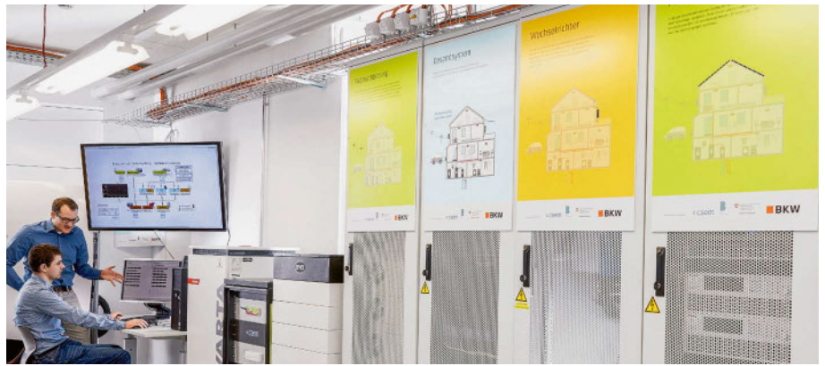
Steffen Wienands (debout) en compagnie d'un autre scientifique dans le « Prosumer Lab » de la Haute école spécialisée bernoise – Technique et informatique – à Bienne. Un algorithme simple a été développé et testé ici pour la commande de batteries de stockage en fonction du réseau.
