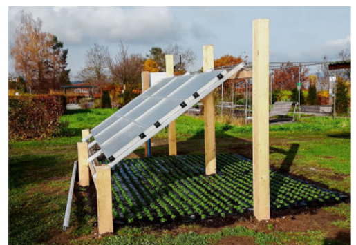
Versuchsanlage der ZHAW in Wädenswil. Unter den Photovoltaikmodulen wächst Nüsslisalat.
