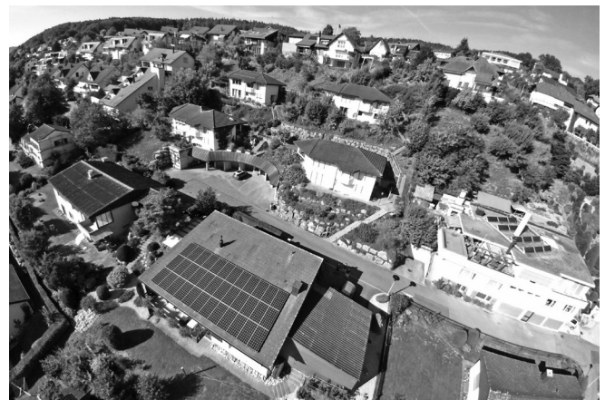
PV-Anlage 10.8 kW (ca. Fr. 30'000), Speicher 6.5 kWh (ca. Fr. 11'000), Wärmepumpe 13.5 kW (ca. Fr. 30'000)
