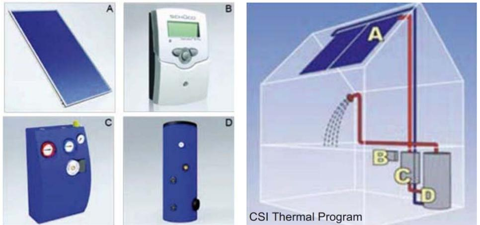
Die thermische Solaranlage besteht aus einem Kollektor (A), welcher die Sonnenstrahlung in Wärme umwandelt, einem Solarwärmespeicher (D), der die nicht sofort genutzte Wärme speichert sowie dem verbindenden Solarkreislauf, über den die Wärme vom Kollektor in den Speicher transportiert wird. Dieser besteht aus Rohren, Armaturen und einer Umwälzpumpe (C), die den einwandfreien Betrieb der Anlage sichern, sowie einer Steuerung (B), welcher den Wärmetransport ein- und ausschaltet.
