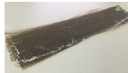
Materialprobe aus Flachs & Leinsamenöl
